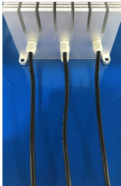
图 2 电调三相输出线
